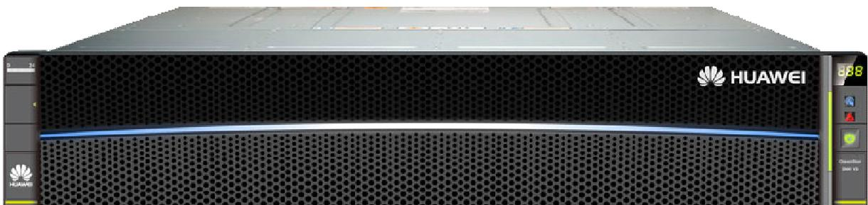
В качестве хранилища данных используется СХД Huawei OceanStor 2600 V3. Система поддерживает полезную ёмкость хранения до 5 ПБ за счет возможности масштабирования до 4 контроллерных пар, и увеличения объёма кэш-памяти
